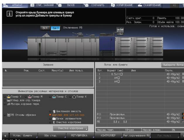
Добавьте клеевые гранулы в **устройство клеевого скрепления PB-503**.
