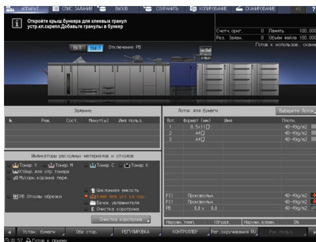
Добавьте kleевые гранулы в **устройство kleевого скрепления РВ-503**.
