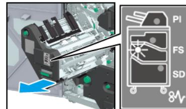
**3** Поверните ручку [FS8] и вытяните вертикальную выравнивающую планку укладчика.
