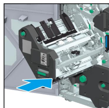
→ Если вертикальная выравнивающая планка сталкивается с аппаратом в любом месте, она блокируется и возвращение укладчика в исходное положение оказывается невозможным. Поверните ручку [FS8] для разблокировки и верните укладчик в исходное положение.
